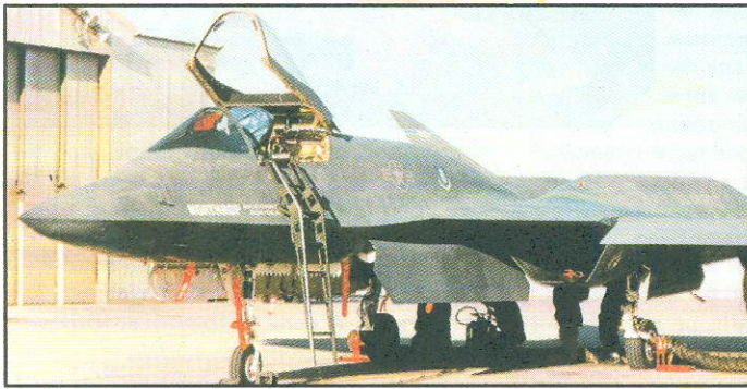
Конкурент F-22 по конкурсу – YF-23. Обрати внимание на типичные элементы так называемого стэлс-дизайна: практически полное отсутствие прямых углов в конструкции самолета
